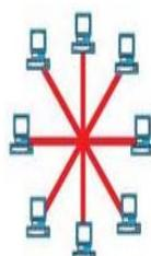
**مميزاته:** يوصل كل جهاز بواسطة سلك خاص مع جهاز توزيع مركزي سهلة إضافة جهاز جديد إلى الشبكة، وذلك بوصله مع جهاز التوزيع المركزي بسلك فشل أحد الأسلاك يؤدي إلى تعطيل الجهاز الموصول مع السلك المعطوب، دون أن يؤثر على عمل بقية الشبكة
